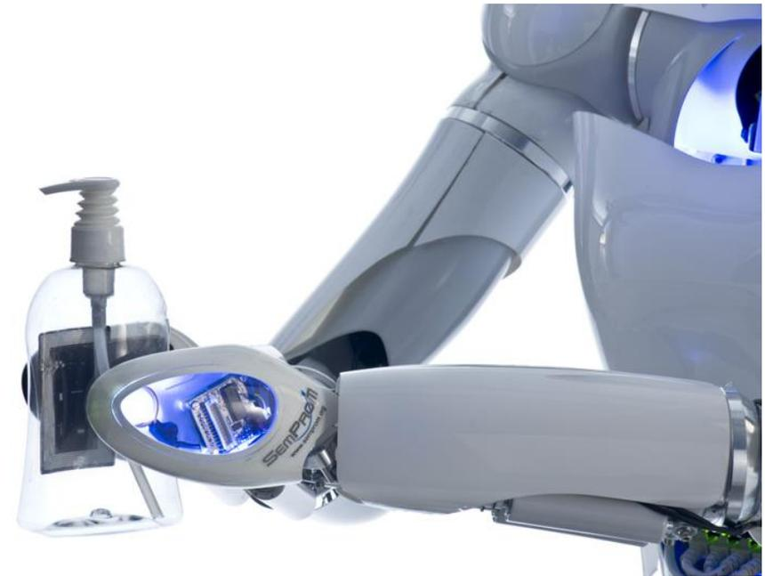
Auslesen von Größe, Gewicht und Griffpunkten aus dem Produktgedächtnis mit einer in der linken Hand integrierten Antenne.
