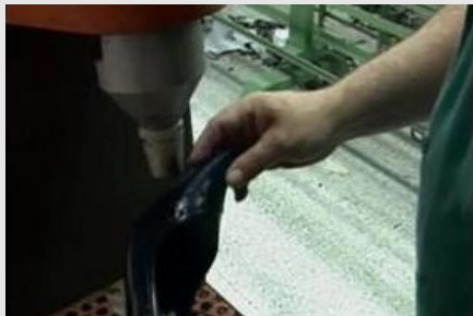
Abschließendes manuelles Bügeln des Leders ohne den Leisten
