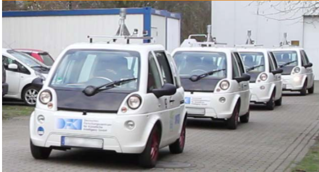
Konzept: Fahrzeuge fahren autonom in Kolonne mit virtueller Deichsel
