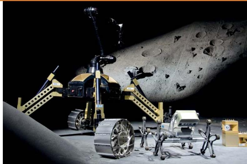
Der Mondrover Sherpa, der Laufroboter Asgard sowie Kommunikationsmodule (v.l.n.r.) zählen zu den DFKI-Systemen, die im Projekt „TransTerra“ weiterentwickelt und auf irdische Anwendungsfelder übertragen werden
