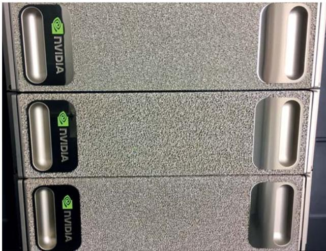
Äußerlich unscheinbar: Drei DGX-1 Deep Learning Supercomputer mit zusammen 3 Petaflops und ca. 10 kW maximaler Leistungsaufnahme.
