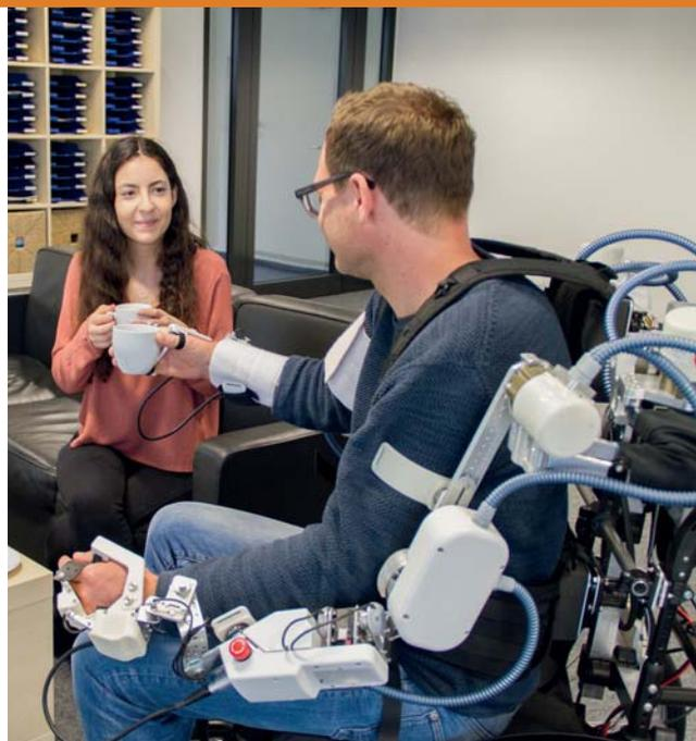
modi wählen. So lässt sich z.B. durch die Bewegung eines Armes der andere mitbewegen oder das Exoskelett ermöglicht die Steuerung der Bewegung, die von einer dritten Person durch Führung eintrainiert wurde. Zudem lässt sich das System mithilfe der Muskelaktivität des Patienten steuern: Auf Basis der gemessenen Elektromyografie-Signale kann es die Bewegungsabsicht des Patienten ableiten und ihn in seinen Bewegungsabläufen intuitiv unterstützen.
