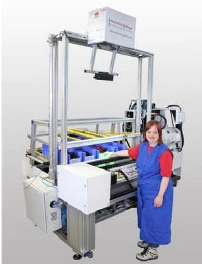
Abbildung 1: Einzelarbeitsplatz mit Assistenzsystem zur Montage von Schraubzwingen
