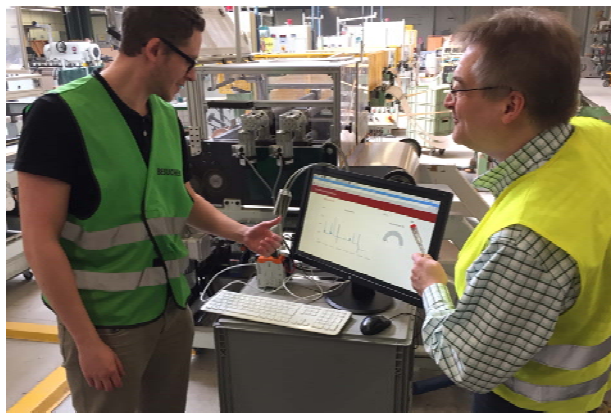
Abbildung 3: Edge Device inkl. GUI an der Stanzmaschine
