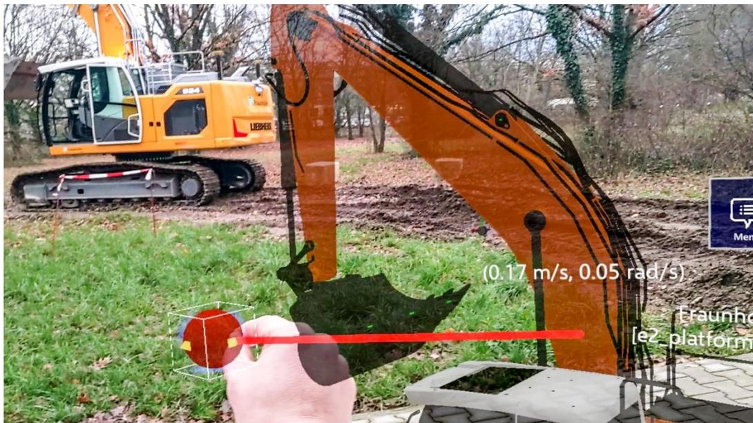
Abbildung 10: Steuerung des Baggers durch Handgesten, Sicht des Benutzers. In der Datenbrille wird dem Nutzer das Baggermodell zur Steuerung eingeblendet. Mit der Hand wird ein virtueller Anfasser (rote Kugel) gegriffen und damit der Bagger bewegt. (Bild: KIT-ISAS)
