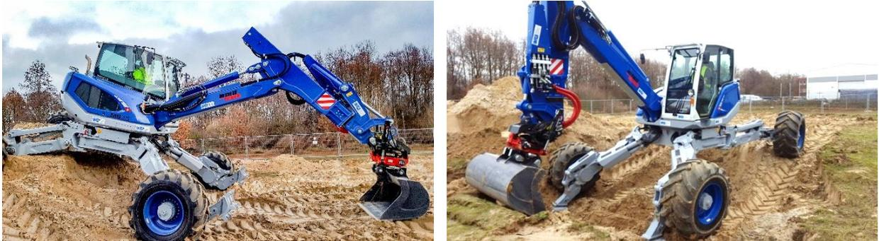
Abbildung 2: Schreitbagger als Basis des Realisierungsprojekts „Dekontamination von Deponien“ im Rahmen von ROBDEKON
