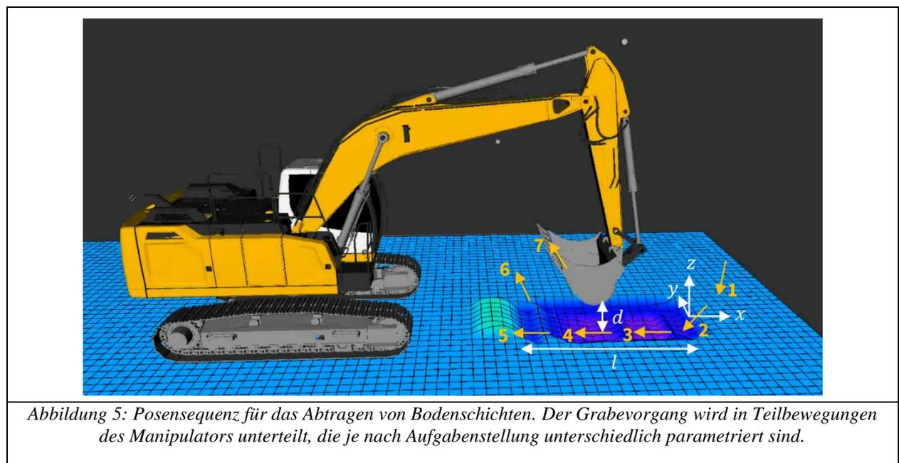
Abbildung 5: Posensequenz für das Abtragen von Bodenschichten. Der Grabevorgang wird in Teilbewegungen des Manipulators unterteilt, die je nach Aufgabenstellung unterschiedlich parametrisiert sind.
