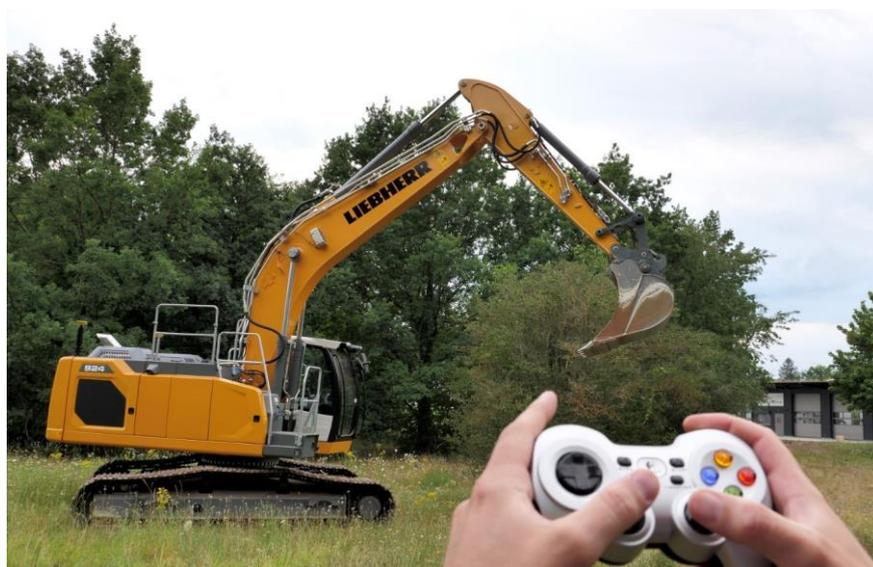
Abbildung 9: Fernsteuerung des Kettenbaggers per Gamepad
