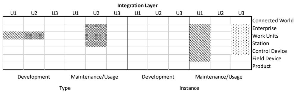
Die konkrete Ausprägung der Integrationschicht folgt den Notwendigkeiten der Kommunikationsschicht. Für eine volle Ausschöpfung der Adaptionmöglichkeiten von AWD müssen in der Regeln Treiber entwickelt werden, die die Steuerungen und Sensoreinheiten der Maschinen zugänglich machen, sowie Adapter zu ERP-System, um Informationen über betriebliche Prozesse und Mitarbeiter zu erhalten.
